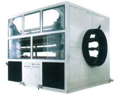
TWELVE-CLAW HAUL-OFF UNIT 十二爪牵引机
